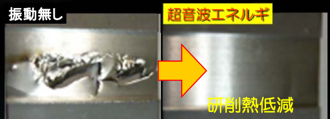
SUS304の薄板(t=0.2)研削
